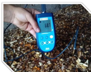
Fig. 5 – Foto tirada após 20 minutos da aplicação do ACE, registrando temperaturas superiores a 65° C.
